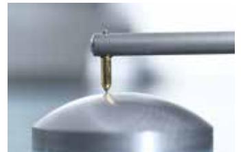
Ha nacido un diamante. Arriba: cada cúpula es sometida a un corte de alta precisión por láser para eliminar cualquier posible irregularidad de su superficie y a continuación es medida para asegurar una forma uniforme. Derecha: un grupo de cúpulas ya terminadas, completadas con su revestimiento protector de platino.
